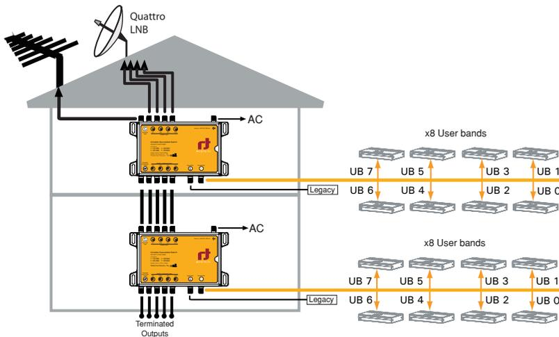
Verbinden Sie die Kabel vom Quattro-LNB mit den Eingangsanschlüssen LNB V / L, V / H, H / L und H / H-Eingänge (achten Sie auf die Identifizierung der Quattro-LNB-Anschlüsse). Der Multischalter ist mit einem terrestrischen Eingang ausgestattet. Schließen Sie die terrestrische Antenne an diesen Eingang:
