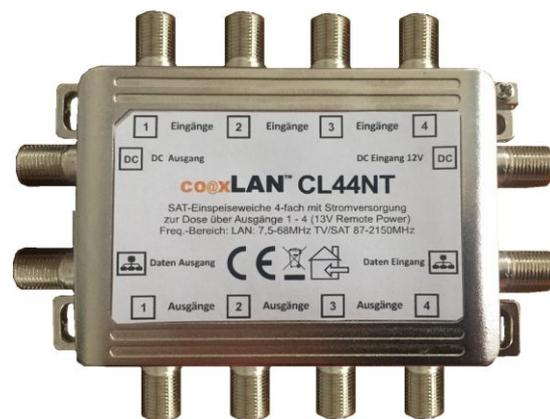
Bei der Nutzung mehrerer CL44-Einheiten muss darauf geachtet werden, dass über das jeweils mitgelieferte Netzteil nur MAXIMAL 8 Modems versorgt werden, da das Netzteil ansonsten überlastet wird. Die CL44 lassen sich auf dem DC- und dem Datenkanal kaskadieren, jedoch muss hierbei darauf geachtet werden, dass maximal 2 Stück CL44 mit einem Netzteil versorgt werden. Auf dem Datenkanal können bis zu 10 Stück CL44 NT kaskadiert werden (abhängig von verwendeten Kabellängen und der Kabelqualität).
