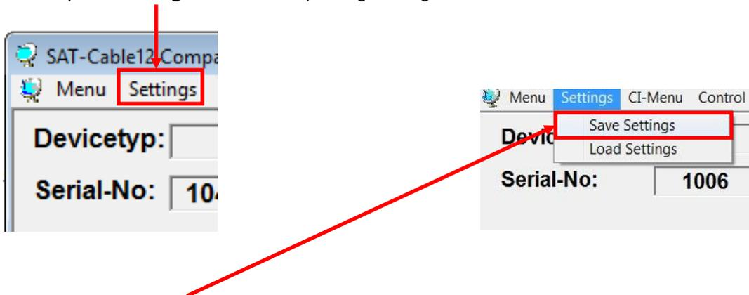
Mit dem Menüpunkt **Save Settings** ist eine Speicherung der Programmierung auf einen PC/Laptop möglich.
