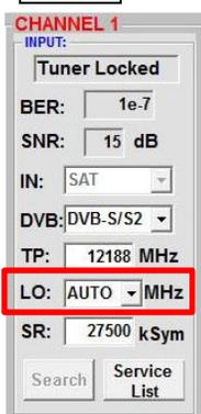
Die benötigte Frequenz wird automatisch eingestellt, kann aber auf **09750**, **10600** oder eine andere **OTHER** Frequenz eingestellt werden.
